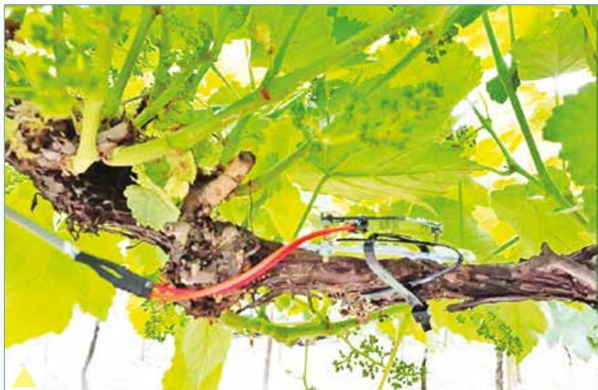
SÃO INSTALADOS no vinhedo pluviômetro, sensor de umidade e termômetro
